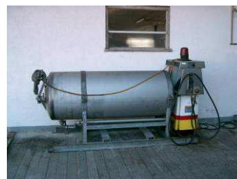
Petite cuve de stockage d'huile équipée d'une pompe à carburant
